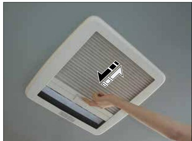
Fig. 17 Tettuccio sollevabile ribaltabile Mini: Apertura dell'avvolgibile oscurante
